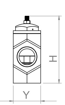
Açıklama : ZM-20 valfi 15-37 Kw [20-50 Hp] gücündeki vidalı hava kompresörlerini destekleyecek kapasitededir.
