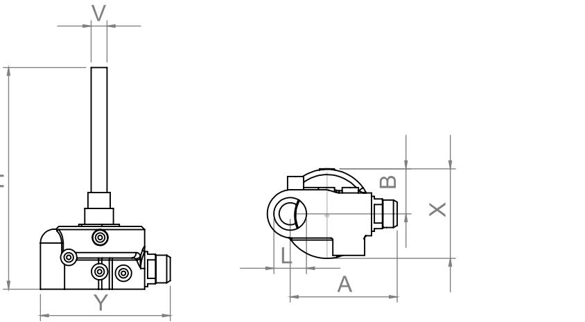
Açıklama : ZM-10 valfi 4-11 Kw [5,5-15 Hp] gücündeki vidalı hava kompresörlerini destekleyecek kapasitededir
